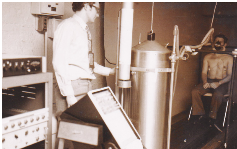
Slika 3: Kimograf, s katerim sem opravljal meritve v New Yorku leta 1974. Prostovoljec je bil sodelavec, strojni inženir Janez Pipan, s katerim sva bila istočasno na podiplomskem usposabljanju.
